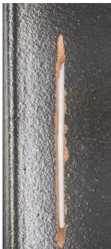
Standard-Schnittbreite bei Ø 230 mm: ca. 3,2 mm
