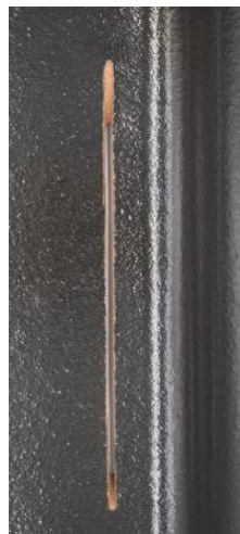
AkkuMAX -Schnittbreite bei Ø 230 mm: ca. 1,76 mm
